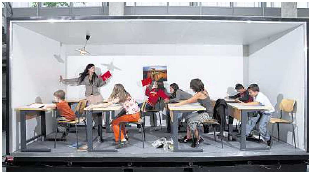
Computergesteuerte Hydraulik versetzt den Container in Schwingung: Erdbebensimulator der ETH Zürich.
